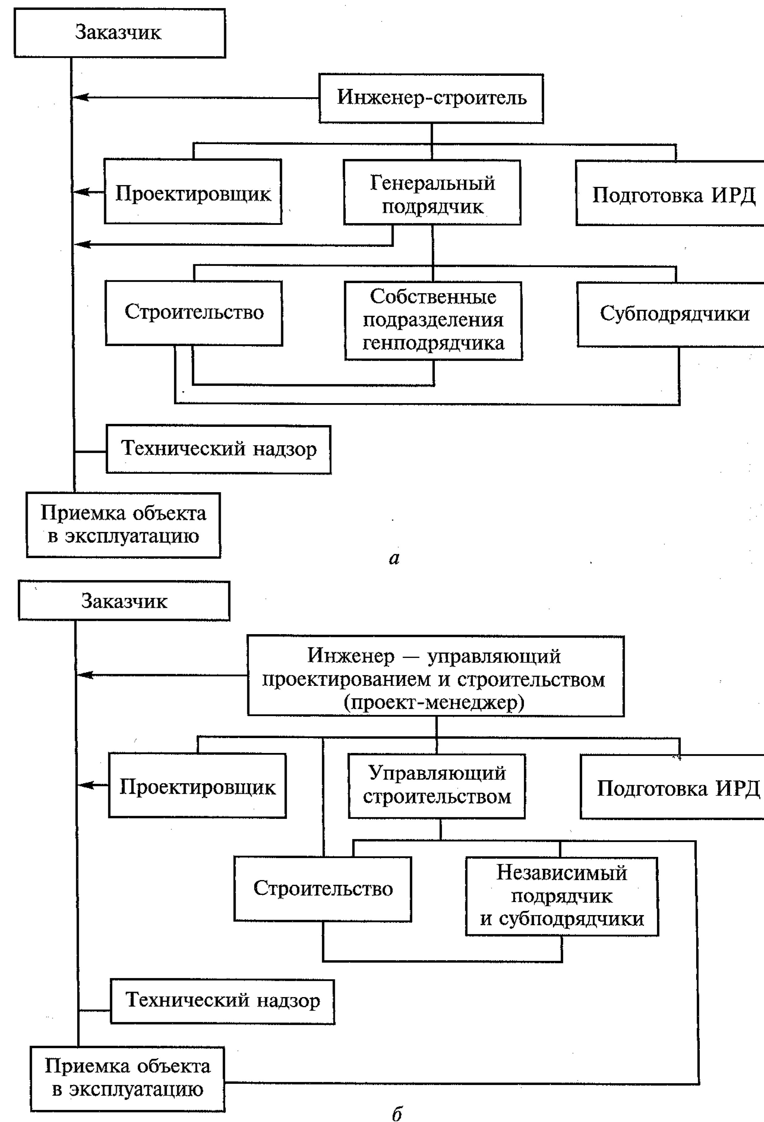
Рис. 1.8. Схема формы профессионального управления строительством под «ключ»:
