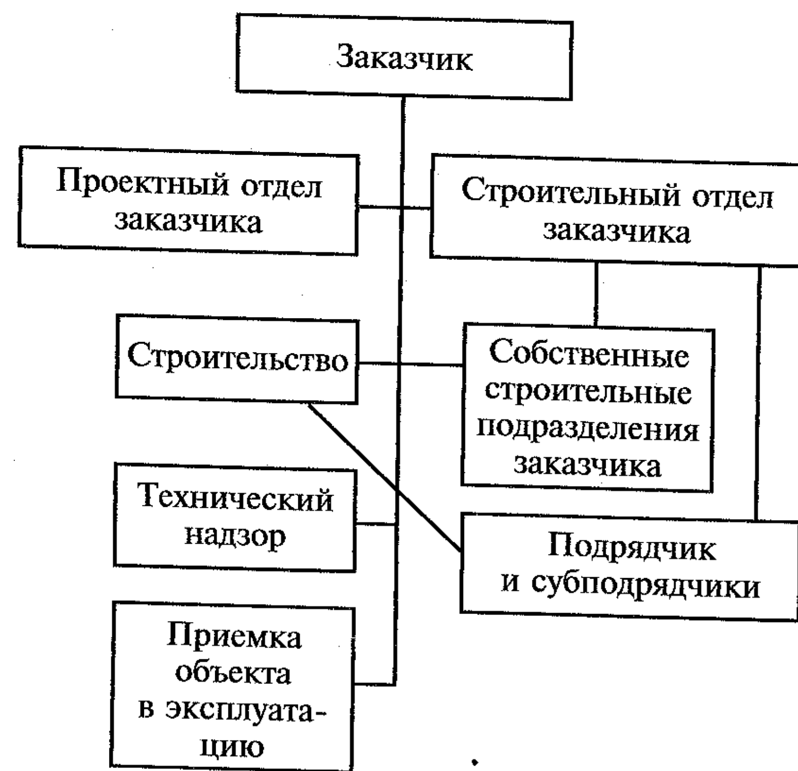
Рис. 1.9. Схема хозяйственной формы управления проектированием и строительством
