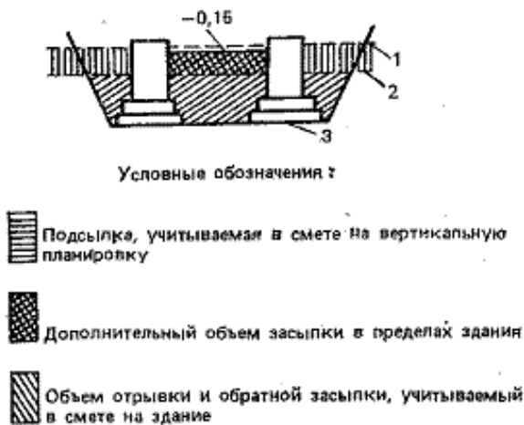
Рис. 6. Схема разработки котлована с распределением доли грунта, относимой к различным сметам, в том случае, когда на площадке предусмотрена подсыпка:
